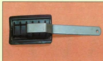
**3.** Inserte la herramienta de instalación detrás del empaque inferior de la compuerta.
