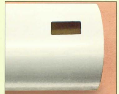
**2.** La ranura en la tubería debe medir 1.25" x 3.325"
